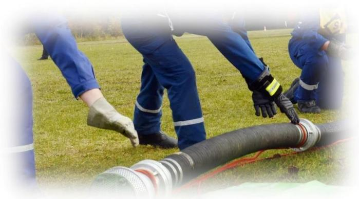
Demonstration des Aufbaus einer Saugleitung durch Wasser-, Schlauchtrupp und Maschinist.
